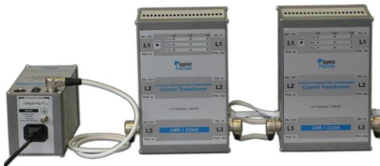
Источник питания PSCI 1220A, подключенный к трансформаторам ПРИЗМА-ТТ
