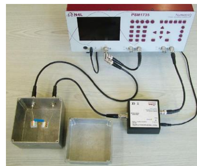
Использование трансимпедансного усилителя TA107
